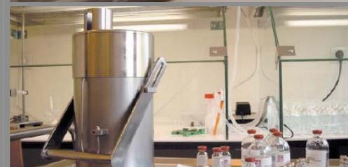
Générateur tungstène/rhénium 188 servant à la production d'isotopes développé par l'IRE.
