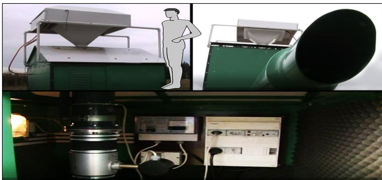
Collecteur de particules du réseau de surveillance Helvétique
