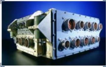
**Le FADEC - Full Authority Digital Electronic Control ou Boîtier de régulation électronique à pleine autorité** - est l'organe de régulation du moteur et l'un des plus gros ECU\* que l'on trouve à bord des avions. Il s'agit d'un dispositif électronique à base de microprocesseurs.
