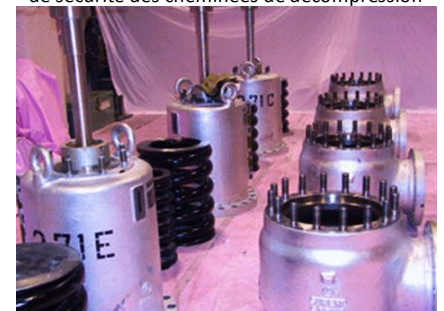
Fukushima : soupapes, ressorts tarés et valves sécurité cheminées décompression - ZOOM
