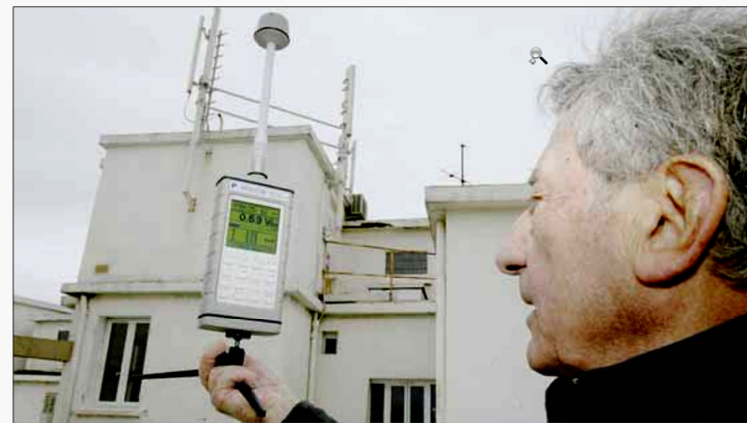
► Les champs magnétiques varient en fonction du nombre d'appels que l'antenne enregistre (jusqu'à 80). Aussi, à 1 seconde d'intervalle, le rayonnement varie de 0,25 à plus de 10V/m. / PHOTO JÉRÔME LIÉGEAIS
