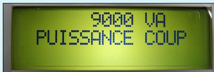
9000 VA PUISSANCE COUP = 9 kVA PUISSANCE COUPURE NETTE BREAKER INTÉGRÉ LINKY
