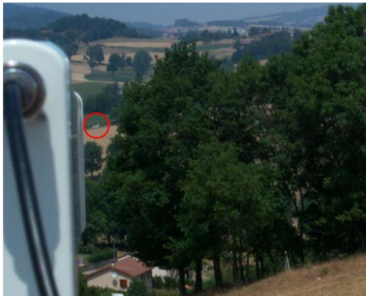
Lors des transferts pour évaluer l'influence des arbres. Au premier plan, une antenne Micronet directionnelle (14 dBi)
